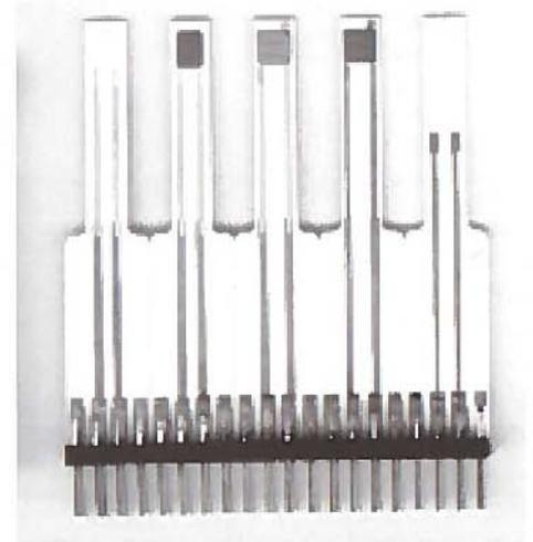
Abb. 1: Dickfilm-Sensor-Array zur kostengünstigen Bestimmung von Stoffkonzentrationen in der Raumluft.
